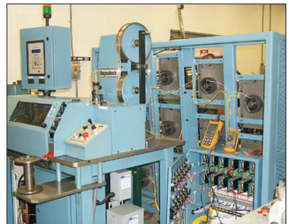
Araç Lastiği Fabrikası Çelik Kord Teli Tansiyon Kontrol Uygulaması FAT50 Fren ve PLP05 Analog Tansiyon Kontrol Kartları İle
