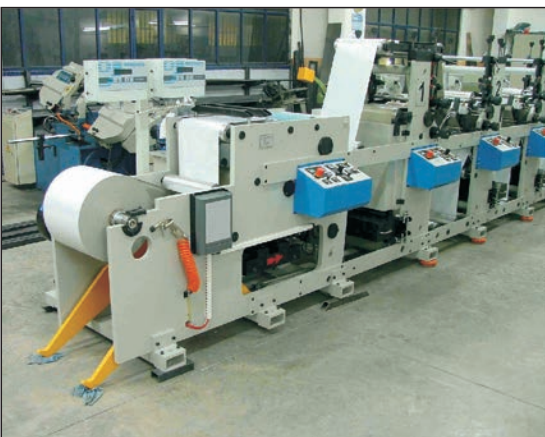
AC Motor Etiket Tifdruk Çözümlü+Ara Çekici Uygulaması DGT2000 + FAT1200
