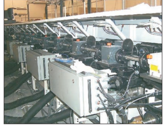
Tıfdruck Baskı Makinası Fazör Dişli Kutusu Uygulaması
