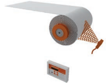
Çap Ölçümü İle Açık Çevrim Kontrolü
