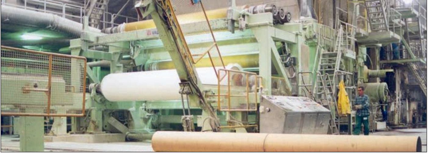
Temizlik Kağıdı Uygulaması (Dört Pnömatik Şaft ile Non-Stop Çalışma)
